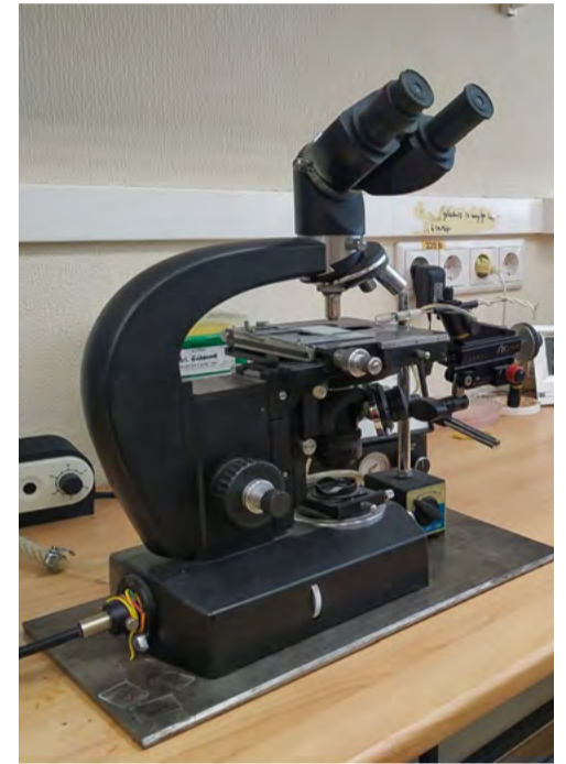
Микроманипулятор (микроинжектор) для получения трансгенных мух
